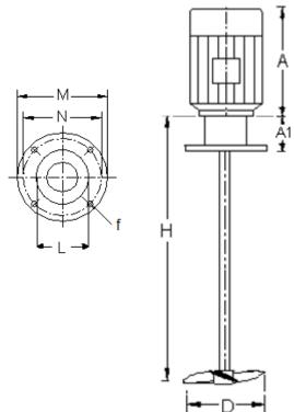
Il gruppo guida è costituito dal solo motore, che ha la flangia di connessione con risalto di centraggio, oppure si possono aggiungere altri componenti:
